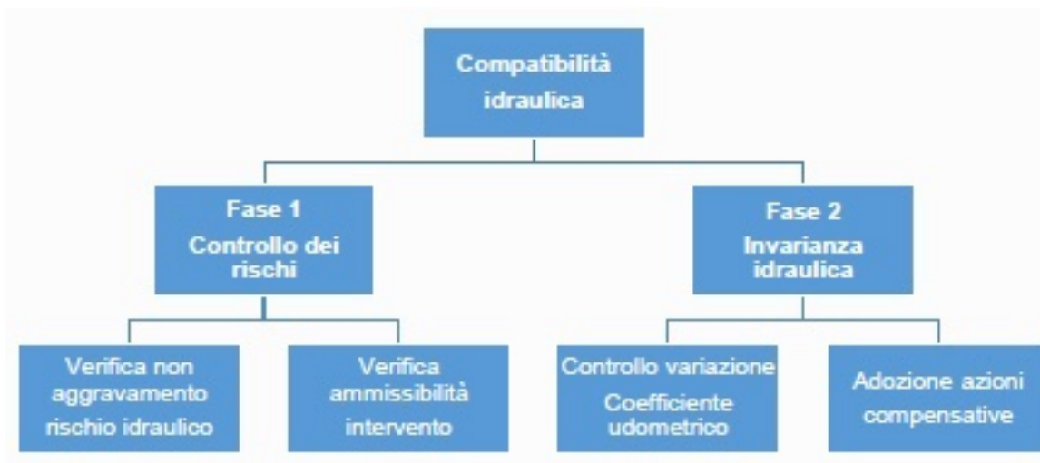
Figura 1- Fasi di realizzazione della VCI
