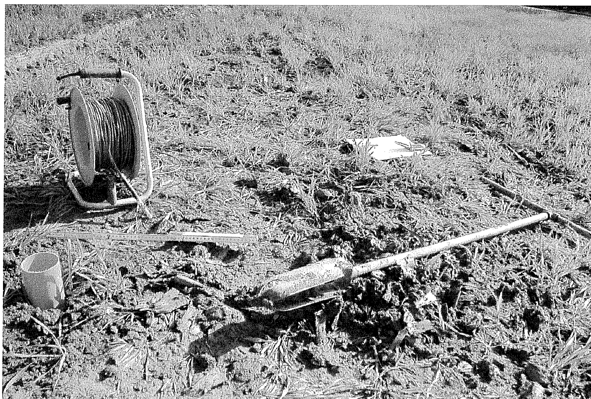
FOTOGRAFIA N° 2 - STRUMENTAZIONE IMPIEGATA PER LA MISURA DELLA PERMEABILITA' SUPERFICIALE
