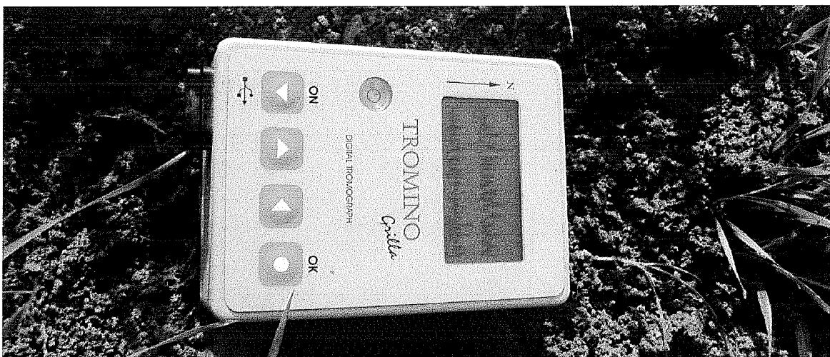
strumento impiegato per l'esecuzione dell'indagine sismica passiva (vedi paragrafo seguente)
